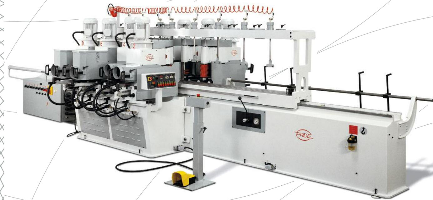
> In opzione la macchina può essere fornita con tavolo inclinabile per tagli fuori squadra. Il movimento del tavolo è motorizzato e raggiunge automaticamente la quota di inclinazione immessa dall'operatore. La costruzione robusta del carro permette di lavorare in modo inclinato senza alcuna vibrazione e con risultati assolutamente perfetti.
