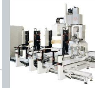
>> VARIO TT è il centro di lavoro con 5 assi in testa, a traversa mobile, di grande rigidità e stabilità. Dotato di 2 banchi di lavoro permette di lavorare pezzi complessi sia in "pendolare" che a tavole unite, per pezzi di grandi dimensioni. La versione con cambio utensile prevede il magazzino a bordo macchina per tempi di cambio estremamente rapidi.
