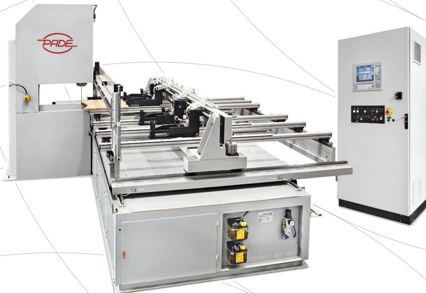
>> PRIMA esegue lavorazioni all'estremità di un pezzo di legno. Il controllo numerico gestisce sia il posizionamento degli assi che il ciclo di tenonatura. Esegue qualsiasi tipo di tenone ed inoltre le operazioni di intestatura e foratura punto/punto.
