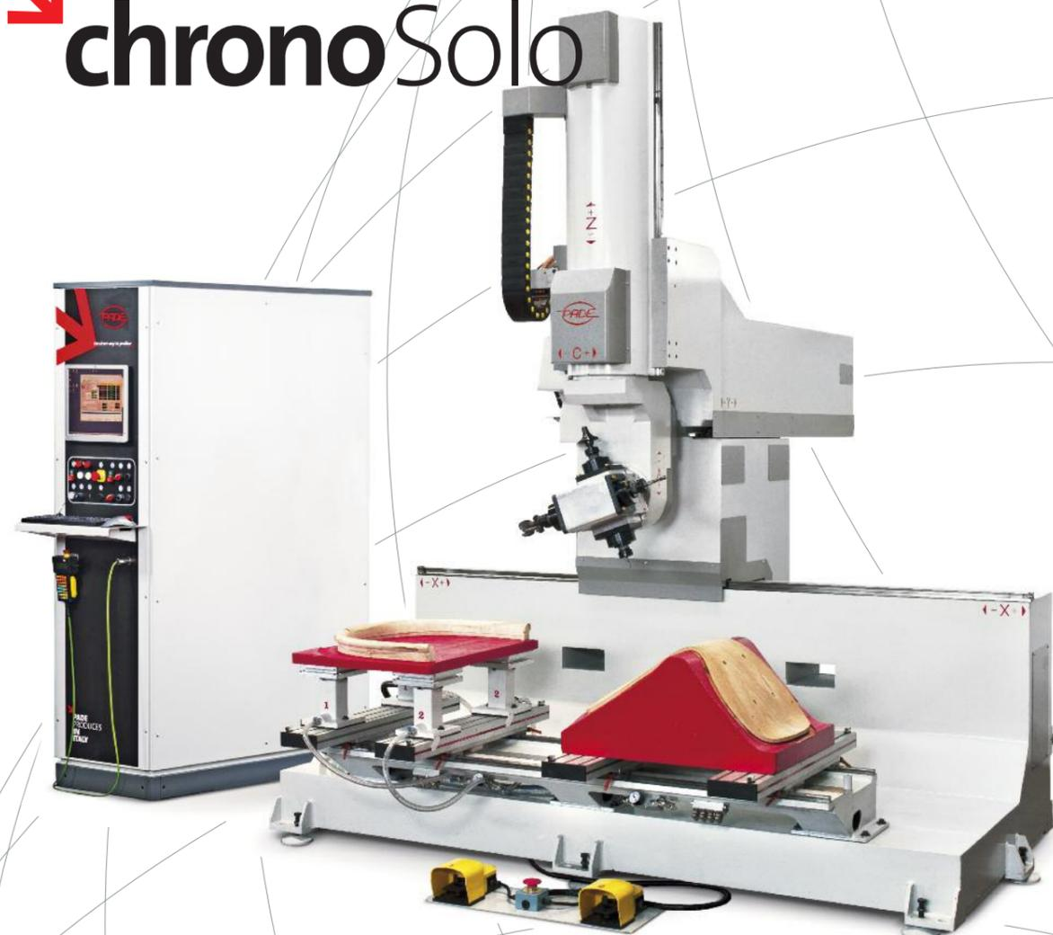
> Le 2 teste possono operare simultaneamente sullo stesso pezzo dividendosi il numero delle operazioni da compiere. Il potente software e-LAB rende la programmazione facile e sicura, grazie alla gestione anticollisione.
