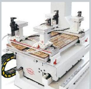
►► SPIN è il centro di lavoro a portale a 6 assi che esegue operazioni di fresatura, foratura e taglio su elementi in legno, plastica, leghe di alluminio e materiali compositi (CORIAN, HI-MAX, ecc.). Ideale per la lavorazione di pezzi complessi con alte velocità di esecuzione. La costruzione rigida e robusta permette corse in Z importanti, con varie misure possibili.
