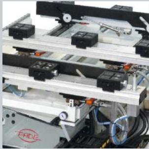
>> CLIPPER/LVT è il centro di lavoro a portale per la lavorazione a 5 assi di elementi complessi sia su elementi di legno massello che pannelli, ed in particolare di porte ed infissi. I tavoli di lavoro sono a traverse mobili con sistema TUBELESS per il bloccaggio dei pezzi.
