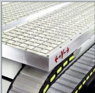
>> SPIN SOLO è il centro di lavoro a portale a 5 assi che esegue operazioni di fresatura, foratura e taglio su elementi in legno, plastica, leghe di alluminio e materiali compositi (CORIAN, HI-MAX, ecc.). E' equipaggiata con un solo tavolo di lavoro. Ideale per la lavorazione di pezzi complessi, SPIN SOLO è disponibile in varie configurazioni, sia per pezzi piccoli che molto grandi. La costruzione rigida e robusta permette corse in Z importanti, con varie misure possibili.
