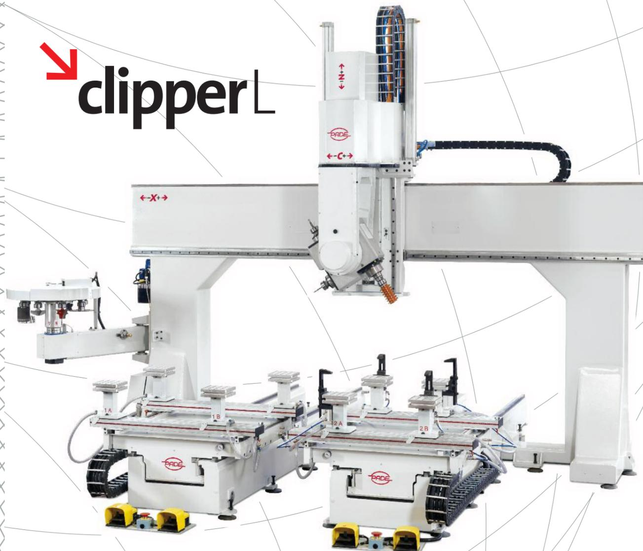
> Le traverse vacuum tipo TUBELESS permettono la collocazione facile ed estremamente veloce delle ventose nella posizione desiderata. Ideale per la lavorazione di elementi di scale, porte e mobili in genere.
