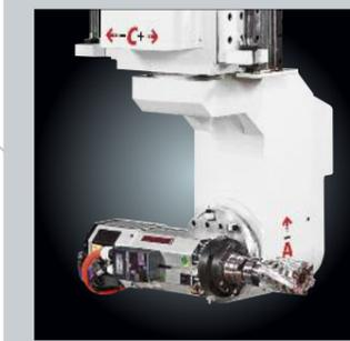
> Testa di lavoro con 1 motore mandrino con potenza a partire da kW 7,5 fino a kW 20 con cambio automatico dell'utensile. Attacco utensile HSK F63 o maggiore. Ideale nelle lavorazioni dove è necessario il minimo ingombro della testa quali, per esempio, la costruzione di stampi. La potenza del motore e la grande coppia la rende anche ideale per la lavorazione di elementi in lega di alluminio, con relativa lubrificazione nebulizzata.
