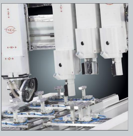
>> SPIN SHAPE è il centro che permette la lavorazione di fresatura contemporanea sui 2 lati di pannelli di varie dimensioni con posizionamento rapido automatico (tramite CN) dei tavoli. La lavorazione contemporanea dei 2 lati e la rapida messa a punto rendono SPIN SHAPE una macchina altamente produttiva ed efficiente anche in presenza di lotti minimi di produzione.
