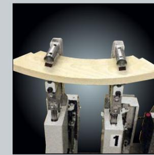
> Sistema di posizionamento automatico in X, Y e Z del sistema di bloccaggio dei pezzi con spostamento tramite C.N. Una volta chiamato il programma i pressori pneumatici di bloccaggio saranno quindi automaticamente posizionati alla posizione programmata in e-LAB.
