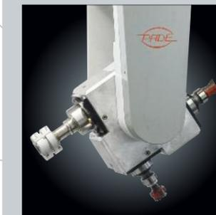
> Una forcella in alluminio temperato, rigida e compatta, nella quale sono alloggiati 3 motori indipendenti, 3 mandrini. Testa composta da 3 motori complanari a configurazione tangenziale, ideale per pezzi complessi che richiedono un motore senza ingombro sottostante. E' possibile così eseguire lavorazioni anche a filo bancale.
