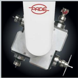
>> CLIPPER è il centro di lavoro a portale a 6 assi che esegue operazioni di fresatura, foratura e taglio su elementi in legno, plastica e in generale su materiale non ferroso. Ideale per la lavorazione di pezzi complessi di dimensioni medie con alte velocità di esecuzione.
