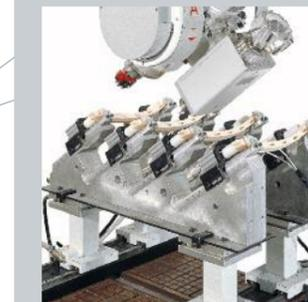
► Soluzione innovativa per il bloccaggio multiplo di pezzi. Consente di ottimizzare i tempi di esecuzione delle diverse lavorazioni, ripetendole in sequenza. Possibilità di montare 2 attrezzature sulla macchina per eseguire pezzi destri e sinistri.
