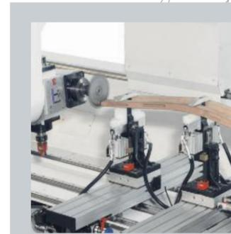
> Sistema di bloccaggio contemporaneo di pezzi sia destri che sinistri, così da poter essere lavorati nello stesso ciclo di lavoro. DOUBLECLAMP si fissa velocemente sulle traverse standard della macchina.
