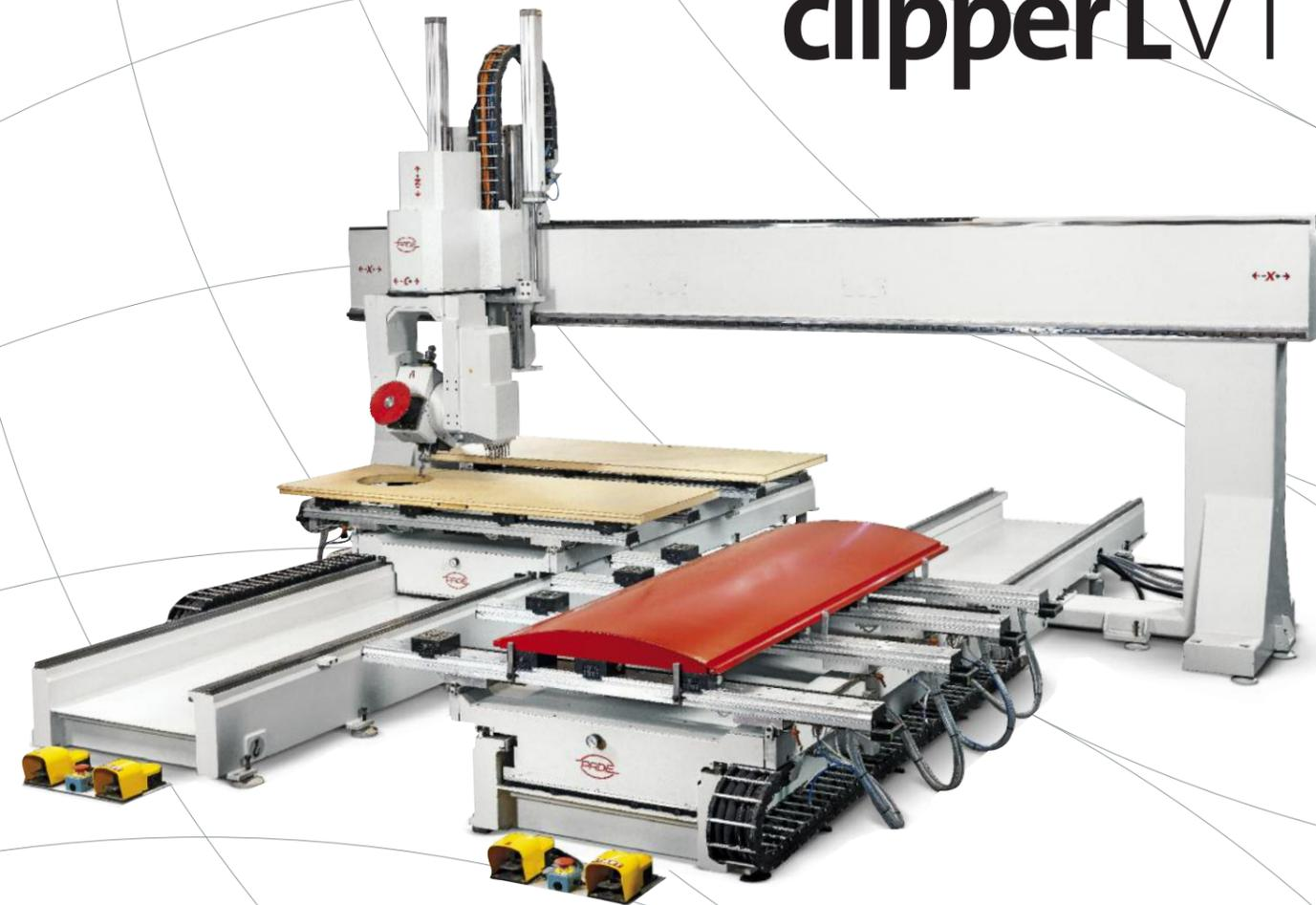
>> CLIPPER SL è il centro di lavoro a 6 assi che esegue operazioni di fresatura, foratura e taglio su elementi in legno, plastica e in generale su materiale non ferroso. Ideale per la lavorazione di pezzi complessi di dimensioni molto grandi con alte velocità di esecuzione.
