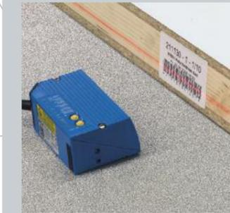
> Possibilità di lettura dei codici a barra del cliente per gestione just-in-time della produzione con caricamento automatico dei programmi e posizionamento automatico dei tavoli per la produzione immediata del pezzo.
