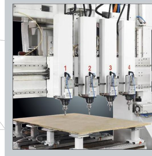
>> SPIN SOLO +ONE è il centro con 2 teste di lavoro opposte e un solo tavolo di lavoro. E' possibile prevedere una macchina con una testa operatrice a 5 assi su un lato e con 1 o più teste a 3 assi sull'altro. Un centro quindi altamente flessibile, capace di lavorare sia pezzi complessi che eseguire semplici lavorazioni multiple. Per grandi quantità.
