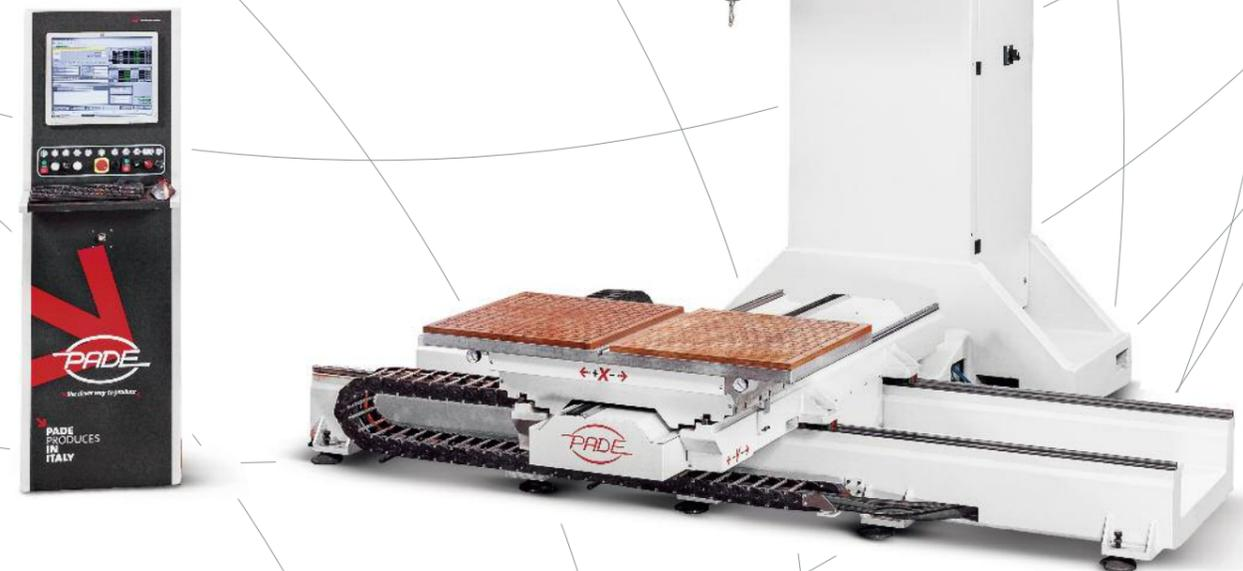
> 3 mandrini di lavoro montati su un supporto monobraccio dove sono allocati 2 motori: uno doppio mandrino ed uno singolo. Il suo ingombro minimo permette lavorazioni in spazi ridotti senza il bisogno di particolari prolunghe utensili.
