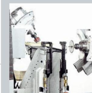
> La macchina raggiunge angoli di inclinazione e rotazioni impossibili per le tradizionali macchine meccaniche: inclinazione e rotazione teste da -60° a +60°. Il controllo numerico gestisce sia il posizionamento degli assi che il ciclo di tenonatura, quindi anche lo spessore e la larghezza del tenone saranno semplici valori da immettere nel programma.
