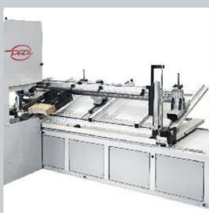
>> Centro 3 assi per il taglio di assi in legno o pannello. Rotazione della lama da -90° a +90° con movimento controllato. Garantisce tagli perfetti e regolazioni rapide ed elimina totalmente il ricorso a controsagome e tracciatura manuale delle assi da tagliare. Disponibile in varie versioni con carico manuale, semiautomatico o completamente automatico.
