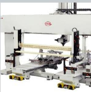
>> VeloxCA è una macchina altamente versatile e quindi utilizzabile sia come classico centro 5 assi per la produzione di pezzi complessi sia come macchina con alimentazione automatica per la produzione di pezzi in serie. Possibile il carico manuale dei pezzi senza l'ingombro dei magazzini frontali, potendoli infatti "parcheggiare" alle estremità della macchina.
