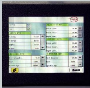
>> Tenonatrice stonante a 2 tavoli di lavoro con ciclo di tenonatura comandato da CN. TF CN riduce drasticamente i tempi di regolazione macchina e garantisce l'esecuzione di tenoni perfetti. Facile programmazione attraverso sistema MACRO di tenoni arrotondati e quadrati, con qualsiasi inclinazione.
